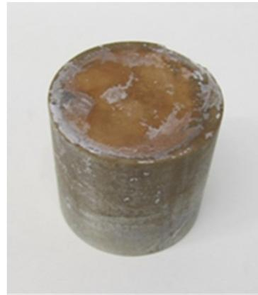
Abbildung 26: Zementkerne eingelagert in reinem überkritischem CO<sub>2</sub>
