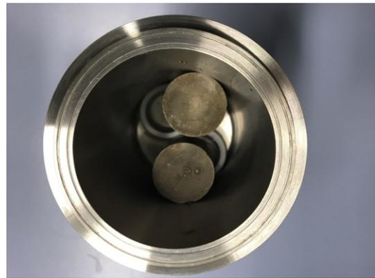
Abbildung 13: Mit Zementkernen gefüllter Autoklav nach sechs Monaten Einlagerung nach dem Öffnen
