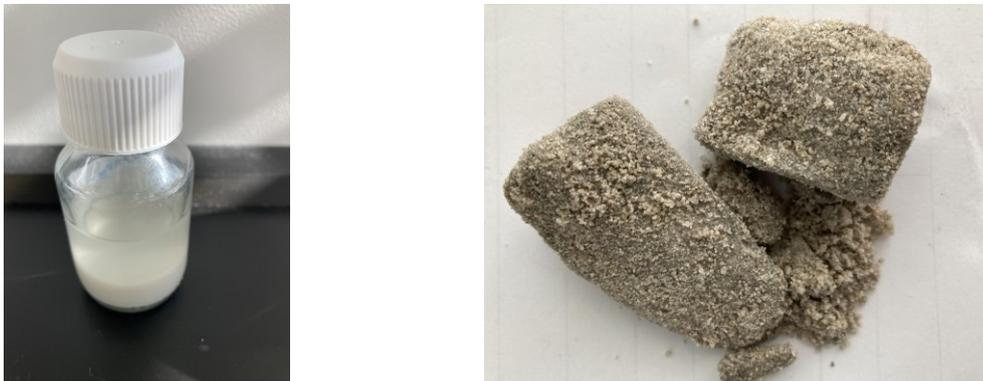
Abbildung 6: Wasser aus dem Permeationsversuch und zerbrochener Kern nach dem Ausbau
