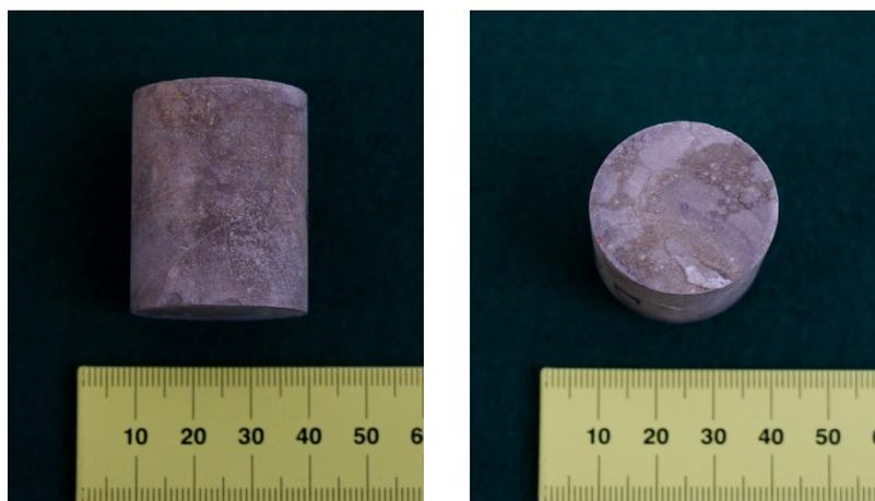
Abbildung 17: Zementkern 4a nach einer Einlagerungsdauer 12 Monaten
