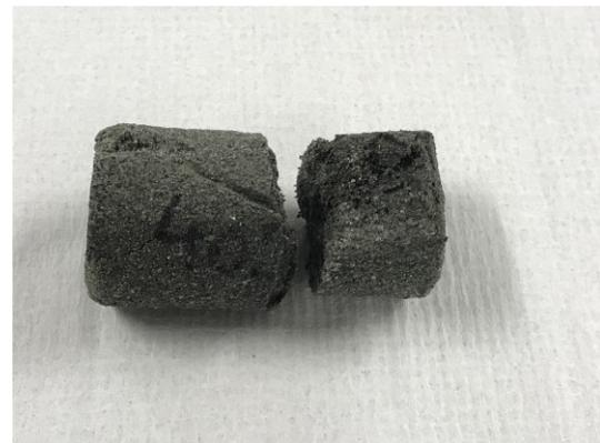
Abbildung 8: Kerne nach der Messung und Ausbau aus der Messzelle.
