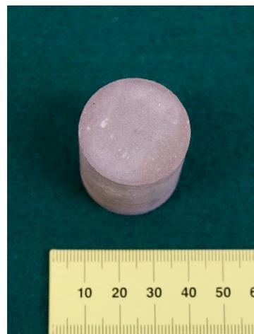
Abbildung 15: Zementkern 5a nach einer Einlagerungsdauer von sechs Monaten
