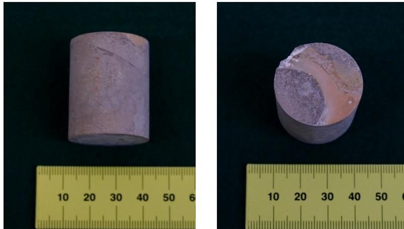
Abbildung 16: Zementkern 3a nach einer Einlagerungsdauer von 12 Monaten
