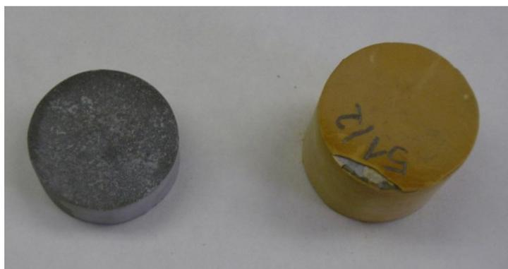
Abbildung 27: Zementkern nach der Herstellung (links) und eingelagert in reinem überkritischem CO<sub>2</sub> (rechts)
