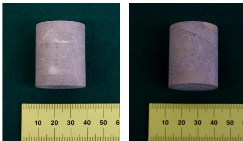
**Abbildung 1.4: Zementkerne nach einer Einlagerungsdauer von sechs Monaten (links) und nach 12 Monaten (rechts)**
