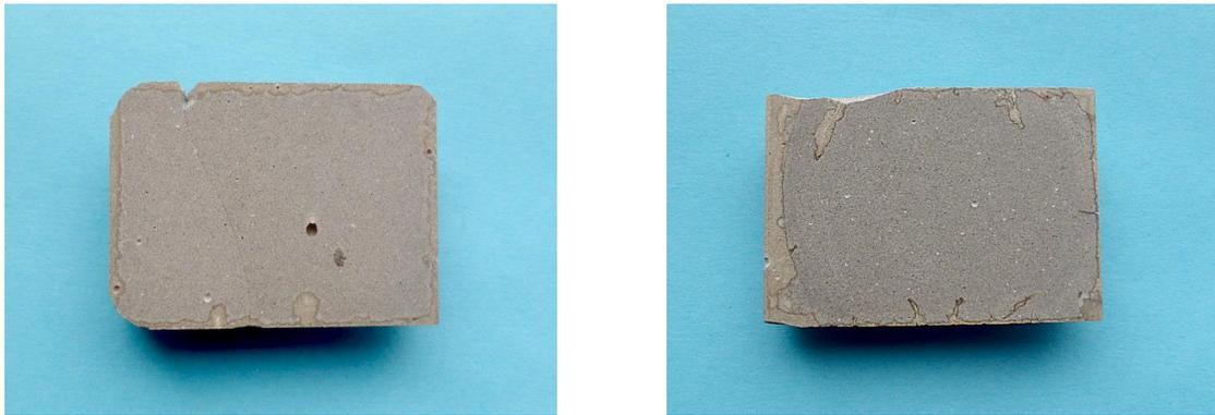
**Abbildung 1.5: Vergleich der Anschliffe der eingelagerten Zementproben links Kern 5a, nach 6 Monaten, rechts Kern 4a nach 12 Monaten**
