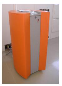
Abbildung 137: Dauertest von Mikro-KWK-Geräten im Demonstrationszentrum am DBI
