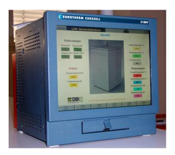
Abbildung 136: Datalogger mit gerätespezifischem Benutzerbildschirm
