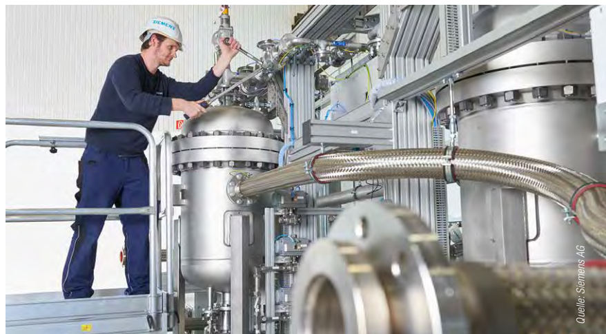
Erneuerbare Energien stellen die Stromnetze vor große Herausforderungen. Helfen können Technologien wie die Elektrolyse. Sie wandelt mit elektrischer Energie Wasser in Sauerstoff und Wasserstoff. Letzterer dient als Speichermedium, Energieträger, CO 2 -neutraler Treibstoff oder Ausgangsstoff für viele industrielle Anwendungen.
