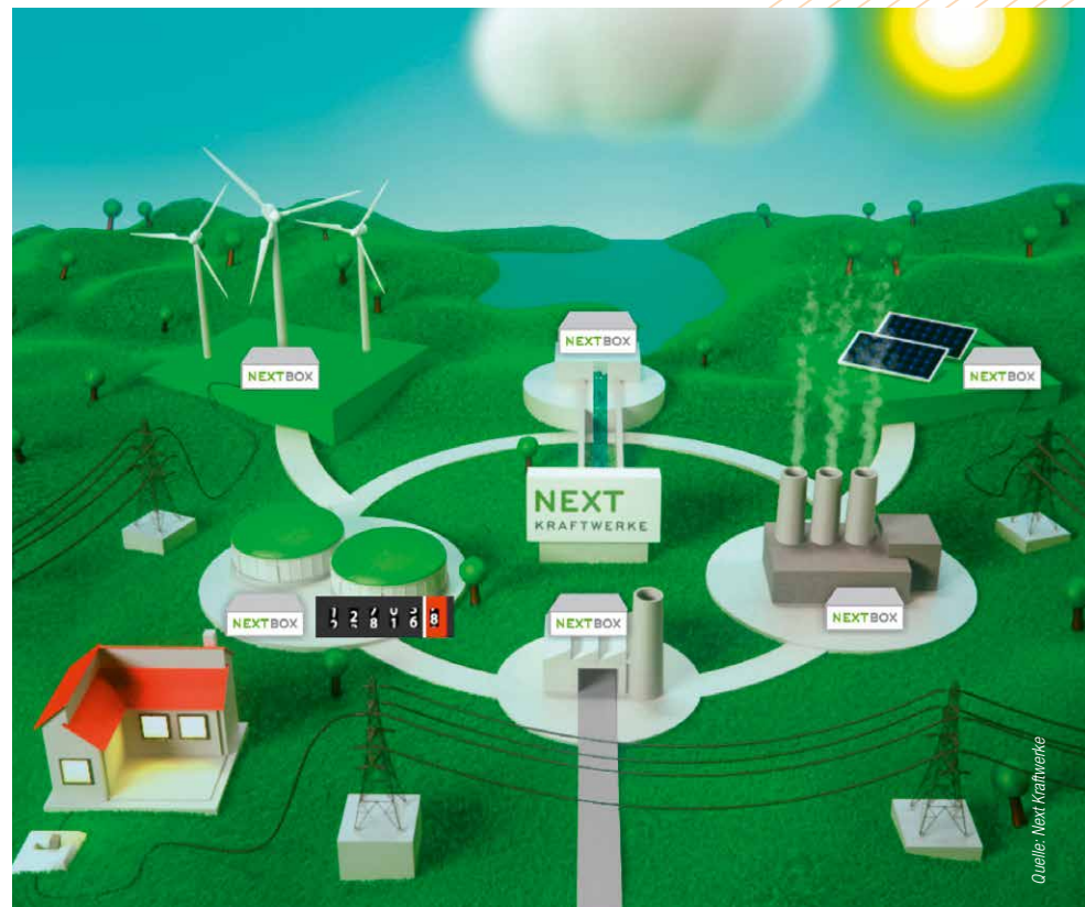
Intelligent vernetzt ist es mit vielen Einzelanlagen möglich, signifikante Mengen an flexibler Leistung zur Stromnetzstabilität in Form von Regelleistung bereitzustellen.
