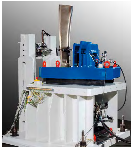
Die MPA der Universität Stuttgart untersucht auf diesem Prüfstand das Ermüdungsverhalten von Turbinenschaufeln unter Lastbedingungen, die typisch sind für eine hochflexible Fahrweise von Kraftwerken.
