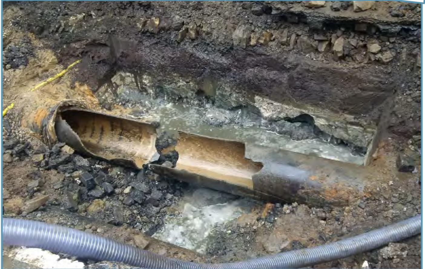
Schalenbruch an einer Wasserleitung DN 500 Material Grauguß
