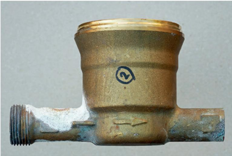
Abb. 4: Wasserzählergehäuse mit Entzinkung, Korrosionsprodukte: weiße Ablagerungen
